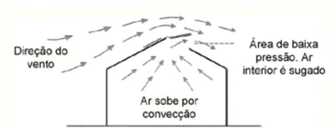
Figura 9 - Ventilação natural em que ocorre ação combinada (somatória) entre os efeitos térmico e por ação dos ventos.
