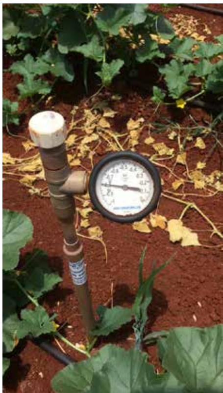
Figura 1 - Tensiômetro instalado na cultura do pepino.
